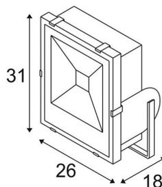
Kraftvoller DISOS LED Strahler zur Beleuchtung von Flächen und Plätzen. Durch den schwenkbaren Montagebügel sowie die Schutzart IP65 ist der Strahler für die Außenmontage an Wand und Boden geeignet. Der elektrische Anschluss des in kaltweiß verfügbaren Strahlers erfolgt durch den verbauten Treiber sowie der Zuleitung direkt an 230V Netzspannung. Zur einfachen Wandmontage sind optional verschiedene Wandhalter erhältlich. Diese Leuchte enthält eingebaute 90W LED-Lampen.
