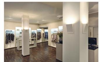
Die Aluminium Wandanbauleuchte DELWA WIDE ist mit zwei leistungsstarken FlächenLEDs der Lichtfarbe warmweiss ausgestattet. Der elektrische Anschluss der aus Aluminium gefertigten Leuchte erfolgt durch den verbauten Treiber an 230V Netzspannung. Durch die Schutzart IP44 ist die in mehreren Farbversionen verfügbare Leuchte für den Außenbereich geeignet.
