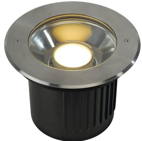
Die begehbare Bodeneinbauleuchte mit runder Edelstahlblende und klarer Glasabdeckung ist zur Aufnahme von Philips Fortimo LED Twistable 1100lm Modulen geeignet. Durch die Schutzart IP67 ist die mit zwei Blendenformen verfügbare Leuchte für den Außenbereich geeignet. Der elektrische Anschluss erfolgt direkt an 230V Netzspannung. Zur einfachen Montage befindet sich ein Einbautopf im Lieferumfang. Zusätzlich besteht die Möglichkeit der Durchverdrahtung.
