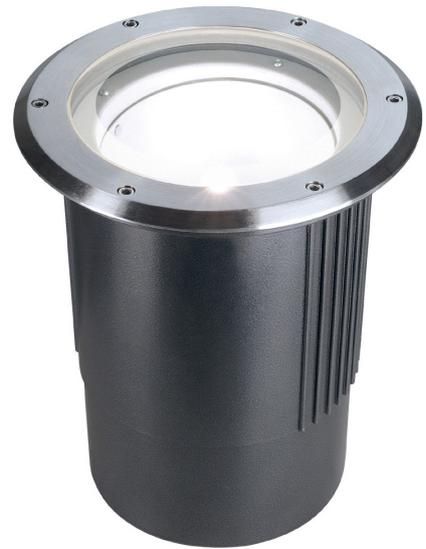
Die begehbare Bodeneinbauleuchte mit runder Edelstahlblende und teilsatiniertes Glasabdeckung ist mit einer schwenkbar G12 Fassung sowie einem Vorschaltgerät ausgestattet und ist somit kompatibel mit Entladungslampen. Durch die Schutzart IP67 ist die Leuchte für den Außenbereich geeignet. Der elektrische Anschluss erfolgt direkt an 230V Netzspannung. Zur einfachen Montage befindet sich ein Einbautopf im Lieferumfang, zusätzlich besteht die Möglichkeit der Durchverdrahtung.
