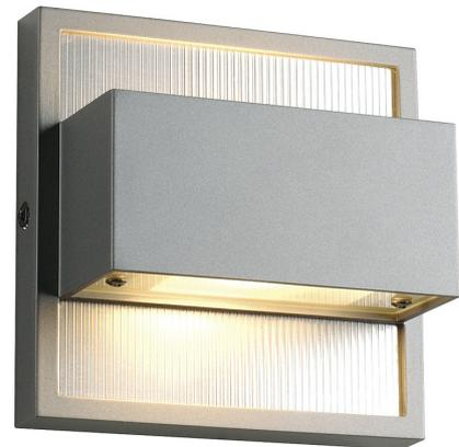
Einflammige Wandanbauleuchte der DACU UP-DOWN Serie bestehend aus Aluminium und satiniertem Glas welches die beiden gegenüberliegenden Lichtauslässe abdeckt (UP/DOWN). Durch Schutzart IP44 für den Außenbereich geeignet. Der elektrische Anschluss der in mehreren Farbversionen verfügbaren Leuchte erfolgt direkt an 230V Netzspannung. Die DACU UP-DOWN Serie beinhaltet des Weiteren alternative Wandleuchten.
