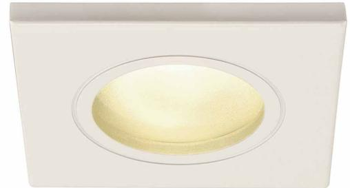
Die DOLIX OUT Niedervolt Deckeneinbauleuchte ist aus Aluminium gefertigt und mit einem Glas zum Schutz gegen Spritzwasser ausgestattet. Mit der Schutzart IP65 ist sie im Außenbereich oder in Feuchträumen einsetzbar. Zum Betrieb der Einbauleuchte wird ein passender Transformator für Niedervolt Halogen Leuchtmittel benötigt.
