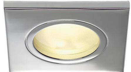
Der DOLIX OUT Hochvolt Deckeneinbauring ist aus Aluminium gefertigt und mit einem Glas zum Schutz gegen Spritzwasser ausgestattet. Mit seiner Schutzart IP44 ist er im Außenbereich oder in Feuchträumen einsetzbar. Dank der eingebauten GU10 Hochvoltfassung ist der DOLIX OUT Deckeneinbauring fertig für den direkten Anschluss an 230V Netzspannung.
