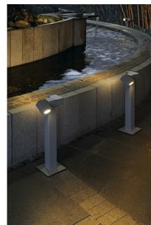
Die aus Aluminiumprofil gefertigte CUBIC PATHLIGHT Standleuchte kann sowohl mit Halogen- als auch mit Energiespar- oder LED-Leuchtmitteln betrieben werden. Mit ihrer Schutzart IP44 ist sie für den Außenbereich geeignet. Die Leuchtmittel sind um 180° schwenkbar. Zur einfachen Montage sind optional Erdspieß und Betonanker verfügbar.
