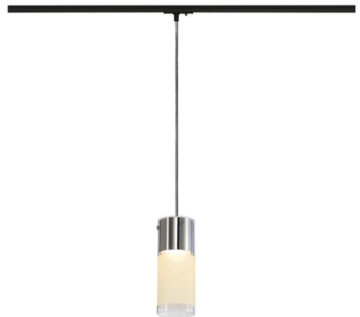
Hochvoltpendelleuchte COMMO mit passendem Adapter für das 1 Phasen Hochvolt Schienen-System. Die aus Stahl und teilsatiniertem Glas gefertigte Leuchte verfügt über ein klares Kabel. Durch den verbauten GX53 Sockel ist die Leuchte für Energiespar- und LED-Leuchtmittel geeignet. Die Pendellänge der in mehreren Farbversionen verfügbaren Leuchte beträgt 1,5m.
