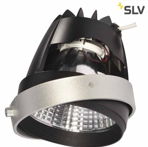
Das COB LED Modul wurde speziell für den Einsatz in AIXLIGHT PRO Einbaurahmen konzipiert. Das warmweiße COB LED Modul ist in weißer oder silbergrauer Ausführung in verschiedenen Abstrahlwinkeln erhältlich. Zum Betrieb wird ein LED Treiber mit einem Konstantstrom von 700mA/ 1000mA oder 1050 mA benötigt. Nicht passend für Flat-Einbaurahmen.
