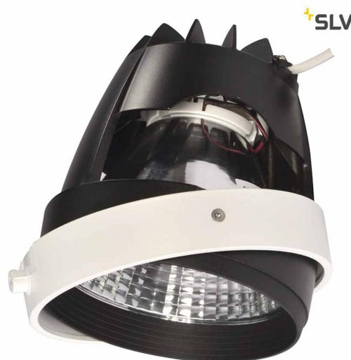
Das COB LED Modul wurde speziell für den Einsatz in AIXLIGHT PRO Einbaurahmen konzipiert. Das warmweiße COB LED Modul ist in weiß matter oder silbergrauer Ausführung in verschiedenen Abstrahlwinkeln erhältlich. Zum Betrieb wird ein LED Treiber mit einem Konstantstrom von 700mA/ 1000mA oder 1050 mA benötigt. Nicht passend für Flat-Einbaurahmen.
