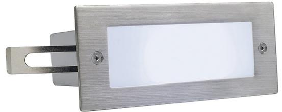
Bei der aus Edelstahl gefertigten Wandinbauleuchte BRICK LED 16 werden die verbauten LEDs von einer opalen Kunststoffscheibe abgedeckt. Der elektrische Anschluss der in mehreren Lichtfarben verfügbaren Leuchte erfolgt direkt an 230V Netzspannung. Durch die Schutzart IP44 ist die Leuchte für den Außenbereich geeignet. Zur einfachen Montage befindet sich ein Einbautopf im Lieferumfang.
