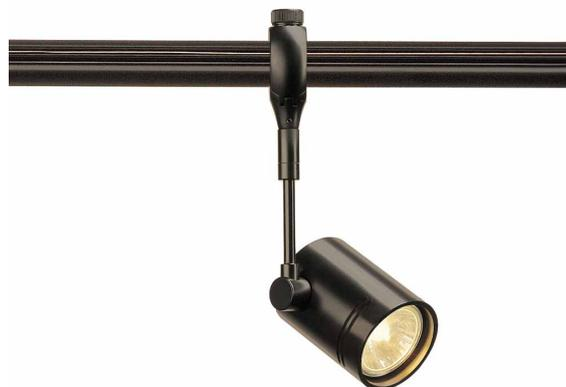
Dreh- und schwenkbarer Hochvoltstrahler BIMA 1 mit passendem Adapter für das EASYTEC II Schienen-System. Die aus Aluminium gefertigte Leuchte ist durch den verbauten GU10 Sockel für Halogen- sowie LED-Leuchtmittel geeignet.+
