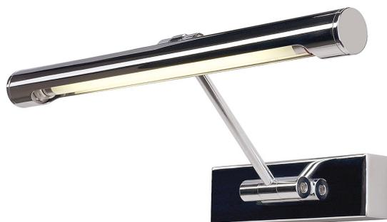
Bilderleuchte für Leuchtstoffröhren bei der Rosette und Kopf über einen Ausleger samt zweier Gelenkstücke verbunden sind. Durch die verbaute G5 Fassung ist die Leuchte zur Aufnahme von 8W T5 Leuchtstoffröhren geeignet. Durch die beiden montierten Gelenke ist die Leuchte perfekt auszurichten. Der elektrische Anschluss der in mehreren Farben verfügbaren Leuchte erfolgt durch das verbaute Vorschaltgerät direkt an 230V Netzspannung.
