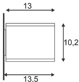
Wandleuchte der BIG THEO Serie gefertigt aus Aluminium und Glas welches das Leuchtmittel abdeckt. Durch die Schutzart IP44 ist sie für den Außenbereich geeignet. Der elektrische Anschluss der in mehreren Farbversionen verfügbaren Leuchte erfolgt an 230V Netzspannung. Die BIG THEO Serie beinhaltet des Weiteren alternative Wand-, sowie Deckenleuchten mit unterschiedlichen Fassungen und ist somit universell einsetzbar.
