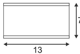
Deckenanbauleuchte der BIG THEO OUT Serie gefertigt aus Aluminium und Glas welches das Leuchtmittel abdeckt. Durch die Schutzart IP44 ist sie für den Außenbereich geeignet. Der elektrische Anschluss der in mehreren Farbversionen verfügbaren Leuchte erfolgt an 230V Netzspannung. Die BIG THEO OUT Serie beinhaltet des Weiteren alternative Wand-, sowie Deckenleuchten mit unterschiedlichen Fassungen und ist somit universell einsetzbar.
