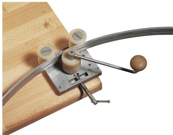
Biegemaschine für das LINUX LIGHT Niedervolt Schienen-System. Ermöglicht das Biegen von Kreisdurchmessern > 40cm.
