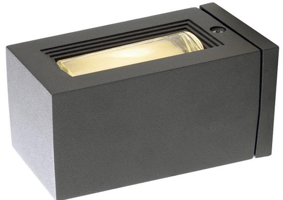
Einflammige aus Aluminium gefertigte Wandaufbauleuchte der OUT-BEAM G9 Serie. Die beiden gegenüberliegenden, mit Glas abgedeckten Lichtauslässe geben jeweils einen engen Beam ab und erzeugen somit den besonderen UP/DOWN Effekt. Durch die Schutzart IP44 ist die Leuchte für den Außenbereich geeignet. Der elektrische Anschluss der in mehreren Farbversionen verfügbaren Leuchte erfolgt direkt an 230V Netzspannung. Die OUT BEAM G9 Serie beinhaltet des Weiteren runde Wandleuchten.
