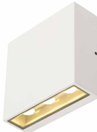
Die mit insgesamt sechs leistungsstarken, warmweißen PowerLED bestückte Wandleuchte BIG QUAD ist in mehreren Farbversionen verfügbar. Durch die gegenüberliegenden Leuchtflächen ergeben sich zwei gleichartige Lichtkegel (UP/DOWN). Der elektrische Anschluss der aus Aluminium gefertigten Leuchte erfolgt durch den verbauten Treiber an 230V Netzspannung. Durch die Schutzart IP54 ist die Leuchte für den Außenbereich geeignet. Die Lampen können in der Leuchte nicht ausgetauscht werden.
