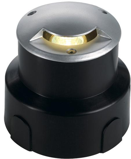
Die begehbare Niedervoltbodeneinbauleuchte AQUADOWN MICRO ist mit einer Aluminiumabdeckung versehen die über einen Lichtauslass verfügt. Durch die Schutzart IP67 ist die Leuchte für den Außenbereich geeignet. Der elektrische Anschluss erfolgt an einem separat erhältlichen 12V Niedervolttrafo. Zur einfachen Montage befindet sich ein Einbautopf im Lieferumfang. Des Weiteren sind Versionen mit zwei bzw. vier Lichtauslässen verfügbar.
