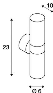
Die Wandleuchte ASTINA besteht aus Aluminium und Glas welches die Leuchtmittel abdeckt. Dank der Position der zwei verbauten Fassungen, erzeugt die montierte Leuchte zwei gleiche, jedoch entgegengesetzte Lichtkegel (UP/DOWN). Durch die Schutzart IP44 ist sie für den Außenbereich geeignet. Der elektrische Anschluss der in mehreren Farbversionen verfügbaren Leuchte erfolgt an 230V Netzspannung.
