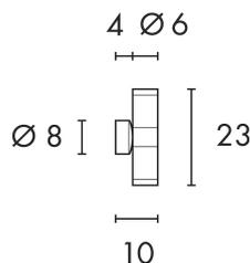
Die Wandleuchte ASTINA UP/DOWN besteht aus Aluminium und Glas welches die Leuchtmittel abdeckt. Dank der Position der zwei verbauten Fassungen, erzeugt die montierte Leuchte zwei gleiche, jedoch entgegengesetzte Lichtkegel (UP/DOWN). Durch die Schutzart IP44 ist sie für den Außenbereich geeignet. Der elektrische Anschluss der in mehreren Farbversionen verfügbaren Leuchte erfolgt an 230V Netzspannung.
