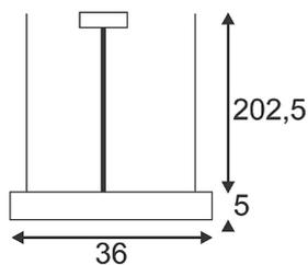
Passend zum Grunddesign der AIXLIGHT R Serie bieten wir mit der AIXLIGHT R2 SQUARE QRB111, wahlweise verfügbar in schwarzer, weißer oder silbergrauer Gehäusefarbe, eine Hochvolt Pendelleuchte zur Aufnahme vierer Niedervolt Halogenleuchtmittel des Typs QRB111. Die Lampenhalter sind kardanisch schwenkbar, was die individuelle Ausrichtung der Lichtkegel garantiert. AIXLIGHT R2 SQUARE QRB111 ist, dank eingebautem, elektronischen Transformator, fertig für den direkten Anschluss an 230V Netzspannung.
