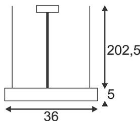
Passend zum Grunddesign der AIXLIGHT R Serie bieten wir mit der AIXLIGHT R2, wahlweise verfügbar in schwarzer, weißer oder silbergrauer Gehäusefarbe, eine Hochvolt Pendelleuchte zur Aufnahme vierer Niedervolt Halogenleuchtmittel des Typs QRB111. Die Lampenhalter sind kardanis schwenkbar, was die individuelle Ausrichtung der Lichtkegel garantiert. AIXLIGHT R2 ist, dank eingebautem, elektronischen Transformator, fertig für den direkten Anschluss an 230V Netzspannung.
