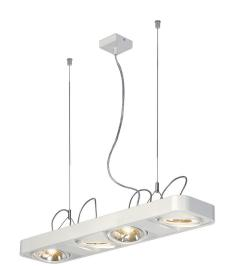
Passend zum Grunddesign der AIXLIGHT R Serie bieten wir mit der AIXLIGHT R2 LONG, wahlweise verfügbar in schwarzer, weißer oder silbergrauer Gehäusefarbe, eine Hochvolt Pendelleuchte zur Aufnahme vierer Halogenleuchtmittel des Typs QRB111. Die Lampenhalter sind kardanisch schwenkbar, was die individuelle Ausrichtung der Lichtkegel garantiert. AIXLIGHT R2 LONG ist, dank eingebautem Transformator, fertig für den direkten Anschluss an 230V Netzspannung.
