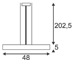
Passend zum Grunddesign der AIXLIGHT R Serie bieten wir mit der AIXLIGHT R DUO QRB111, wahlweise verfügbar in schwarzer, weißer oder silbergrauer Gehäusefarbe, eine Hochvolt Pendelleuchte zur Aufnahme zweier Halogenleuchtmittel des Typs QRB111. Die Lampenhalter sind kardänisch schwenkbar, was die individuelle Ausrichtung der Lichtkegels garantiert. AIXLIGHT R DUO QRB111 ist, dank eingebautem Transformator, fertig für den direkten Anschluss an 230V Netzspannung.
