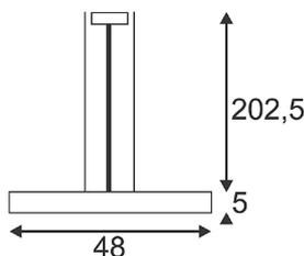
Passend zum Grunddesign der AIXLIGHT R Serie bieten wir mit der AIXLIGHT R, wahlweise verfügbar in schwarzer, weißer oder silbergrauer Gehäusefarbe, eine Hochvolt Pendelleuchte zur Aufnahme zweier Halogenleuchtmittel des Typs QRB111. Die Lampenhalter sind kardanis schwenkbar, was die individuelle Ausrichtung der Lichtkegels garantiert. AIXLIGHT R ist, dank eingebautem Transformator, fertig für den direkten Anschluss an 230V Netzspannung.
