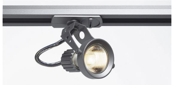
Dreh- und schwenkbarer Hochvoltstrahler AERO GU10 mit passendem Adapter für das 1 Phasen Hochvolt Schienen-System. Die aus Aluminium und Kunststoff gefertigte Leuchte ist durch den verbauten GU10 Sockel für Halogen- sowie LED-Leuchtmittel geeignet.
