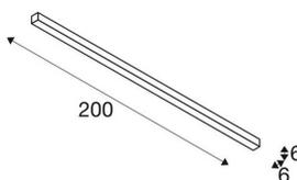
Die Q-LINE Deckenleuchte ist wahlweise ausgestattet mit weißem, schwarzem oder silbergrauem Leuchtengehäuse. Zusätzlich stehen neutralweiße oder warmweiße LED sowie unterschiedliche Abmessungen zur Verfügung. Durch eine hohe Leuchtdichte und einem UGR Wert kleiner 10 sind die Q-Line Leuchten Bildschirmarbeitsplatz tauglich. Aufgrund des TRIAC dimmbaren LED-Treibers ist die Leuchte direkt anschlussfertig für 230 Volt Netzspannung.
