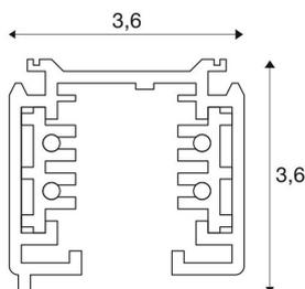
Aluminium Trägerschiene des Hochvolt 3Phasen-Aufbauschiene-Systems. Die Montage kann durch die im Profil vorhandenen Bohrungen direkt an Wand oder Decke erfolgen. Die Aufbauversion dieses Systems ist in mehreren Farben und Längen verfügbar. Alternativ steht des Weiteren eine Einbauversion zur Verfügung.
