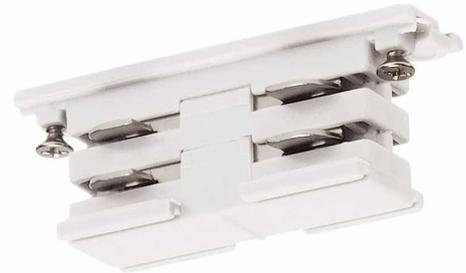
Starrer Verbinder für das Hochvolt 3Phasen-Aufbauschiene-System. Bei abgehängter Montage aus statischen Gründen nur in Verbindung mit Stoßstellenverbinder einsetzbar. Bitte beachten Sie, dass sich der Weißton ab dem 01. Oktober 2018 von RAL 9010 auf RAL 9016 (Verkehrsweiß) ändert.
