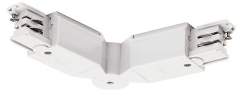
Flexibler Verbinder für das Hochvolt 3Phasen-Aufbauschiene-System. Der in mehreren Farbversionen verfügbare Verbinder ermöglicht Radien zwischen 30° und 330°. Des Weiteren besteht die Möglichkeit der Einspeisung. Bitte beachten Sie, dass sich der Weißton ab dem 01. Oktober 2018 von RAL 9010 auf RAL 9016 (Verkehrsweiß) ändert.
