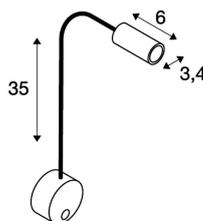
Hochvolt-Displayleuchte für Wandmontage der DIO FLEX PLATE Serie bei der Rosette und Kopf über einen Flexarm verbunden sind. Durch den montierten Schalter ist die individuell ausrichtbare Leuchte für viele Anwendungen geeignet. Der elektrische Anschluss der Leuchte erfolgt direkt an 230V Netzspannung. Als Alternative ist eine LED Version verfügbar.
