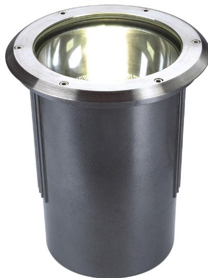
Begehbare Hochvoltbodeneinbauleuchte mit runder Edelstahlblende und klarer Glasabdeckung. Durch die Schutzart IP67 ist die Leuchte für den Außenbereich geeignet. Der elektrische Anschluss erfolgt direkt an 230V Netzspannung. Zur einfachen Montage befindet sich ein Einbautopf im Lieferumfang. Des Weiteren besteht zusätzlich die Möglichkeit der Durchverdrahtung. Als optionales Zubehör ist ein Diffusoreinsatz separat erhältlich.
