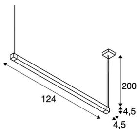
Die OPEN GRILL Pendelleuchte ist eine professionelle Leuchte für die Aufbaumontage. Innerhalb des schwenkbaren Rahmens befinden sich LED's mit 7,5 Watt und sorgen für wahlweise direkte oder indirekte Beleuchtungsattribute. Die OPEN GRILL Pendelleuchte ist für den direkten Anschluss an 230V Netzspannung geeignet.
