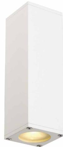
Die Wandaufbauleuchte THEO ist aus Aluminium gefertigt und verfügt über ein Glas, welches die Leuchtmittel abdeckt. Dank der Position der zwei verbauten Fassungen, erzeugt die montierte Leuchte zwei gleiche, jedoch entgegengesetzte Lichtkegel (UP/DOWN) der zum Einsatz gebrachten Hochvolt Halogenleuchtmittel des Typs GU10. Der elektrische Anschluss der in drei Farbversionen verfügbaren Leuchte erfolgt an 230V Netzspannung. +
