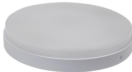
Artea ist eine universelle Wand- /Deckenaufbauleuchte mit Farbwahl von 3000/4000K und Power select mit einer Ausgangsleistung von 10/15/23W und einem Lichtstrom von 1000/1500/2300 Lumen. Somit können Sie vor Ort die gewünschte Lichtfarbe sowie die Helligkeit einstellen und verändern.
