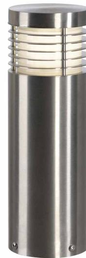
Runde Standleuchte der VAP SLIM Serie gefertigt aus witterungsbeständigem Edelstahl zum direkten Anschluss an 230V Netzspannung. Durch Schutzart IP44 für den Außenbereich geeignet. Zur einfachen Montage sind optional ein Erdspieß sowie ein Betonankerset verfügbar. Als Ergänzung der Serie sind weitere Größen verfügbar.
