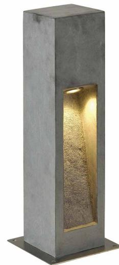
Die indirekt abstrahlende Standleuchte STONE der ARROCK Serie wird aus dem Naturstein Basalt gefertigt und ist mit einer integrierten Premium LED versehen. Mit der Schutzart IP44 ist die Standleuchte für den Außenbereich geeignet. Zur einfachen Montage ist optional ein Erdspieß verfügbar. Der Anschluss erfolgt aufgrund des bereits integrierten LED-Treibers an 230V Netzspannung.
