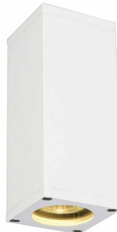
Wandleuchte der THEO Serie gefertigt aus Aluminium und Glas mit einem Lichtaustritt. Durch die Schutzart IP44 ist sie für den Außenbereich geeignet. Der elektrische Anschluss der in drei Farbversionen verfügbaren Leuchte erfolgt an 230V Netzspannung. Die THEO Serie beinhaltet des Weiteren Deckenleuchten und ist somit universell einsetzbar.
