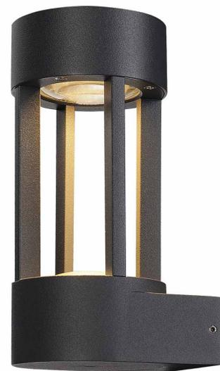
In der aus Aluminium gefertigten Wandleuchte SLOTS WALL wird durch ein COB LED-Modul ein indirekt abstrahlendes warmweißes Licht erzeugt. Mit ihrer Schutzart IP44 ist sie für den Außenbereich geeignet. Die Leuchte ist anschlussfertig für den elektrischen Anschluss an 230V Netzspannung.
