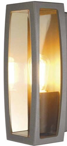
Aus Aluminium gefertigte Wand- und Deckenleuchte der MERIDIAN Serie mit opaler PC Leuchtfläche. Durch die Schutzart IP54 ist die in mehreren Farbversionen verfügbare Leuchte für den Außenbereich geeignet. Der elektrische Anschluss erfolgt direkt an 230V Netzspannung. Die MERIDIAN Serie beinhaltet des Weiteren alternative Wandleuchten in unterschiedlichen Designs.
