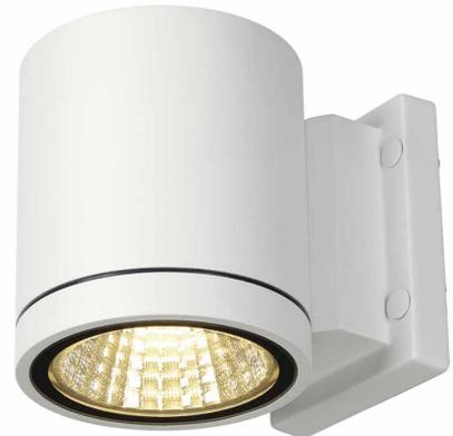
Die puristische Wandleuchte ENOLA\_C besteht aus einer zylindrischen Aluminium Konstruktion und ist bestückt mit einer warmweißen hochleistungs COB LED. Durch den eingebauten LED-Treiber erfolgt der elektrische Anschluss der in weiß und anthrazit erhältlichen Leuchte direkt an 230V Netzspannung. Die Lampen können in der Leuchte nicht ausgetauscht werden.
