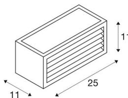
Einflammige Wandleuchte BOX-L bestehend aus lackiertem Aluminium und satiniertem Acryl welches die drei Lichtauslässe abdeckt. Durch Schutzart IP44 für den Außenbereich geeignet. Der elektrische Anschluss der in mehreren Farbversionen verfügbaren Leuchte erfolgt direkt an 230V Netzspannung.
