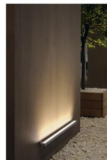
Mit 18 leistungsstarken PowerLEDs bestücktes Aluminiumprofil. Durch die bereits montierten Montagehalter kann die Montage direkt an Wand, Decke und Boden erfolgen. Durch die Schutzart IP65 ist das schwenkbare Profil auch für den Außenbereich geeignet. Der elektrische Anschluss des in tageslicht- und warmweiß verfügbaren Profites erfolgt mittels verbauter Zuleitung an ein 24V Gleichspannungsnetzteil. Diese Leuchte enthält eingebaute LED-Lampen.
