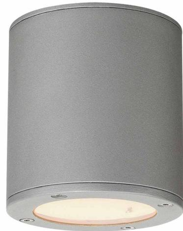
Die Deckenleuchte SITRA besteht aus Aluminium und Glas welches das Leuchtmittel abdeckt. Durch die Schutzart IP44 ist sie für den Außenbereich geeignet. Durch den verbauten GX53 Sockel ist die Leuchte für die Aufnahme von LED und Energiesparleuchtmitteln geeignet. Der elektrische Anschluss der in drei Farbversionen verfügbaren Leuchte erfolgt an 230V Netzspannung.
