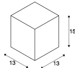
Deckenleuchte der BIG THEO Serie gefertigt aus Aluminium und Glas welches das Leuchtmittel abdeckt. Durch die Schutzart IP44 ist sie für den Außenbereich geeignet. Der elektrische Anschluss der in mehreren Farbversionen verfügbaren Leuchte erfolgt an 230V Netzspannung. Die BIG THEO Serie beinhaltet des Weiteren alternative Wand-, sowie Deckenleuchten mit unterschiedlichen Fassungen und ist somit universell einsetzbar.+
