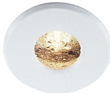
Der OUT 65 Niedervolt Deckeneinbauring ist aus Aluminium gefertigt und mit einem Glas zum Schutz gegen Spritzwasser ausgestattet. Mit seiner Schutzart IP65 ist er im Außenbereich oder in Feuchträumen einsetzbar. Zum Betrieb der Einbauleuchte wird ein passender Transformator für Niedervolt Halogen Leuchtmittel benötigt.
