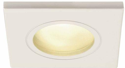
Die DOLIX OUT Hochvolt Deckeneinbauleuchte ist aus Aluminium gefertigt und mit einem Glas zum Schutz gegen Spritzwasser ausgestattet. Mit der Schutzart IP44 ist sie im Außenbereich oder in Feuchträumen einsetzbar. Dank der eingebauten GU10 Hochvoltfassung ist die DOLIX OUT Deckeneinbauleuchte fertig für den direkten Anschluss an 230V Netzspannung.+
