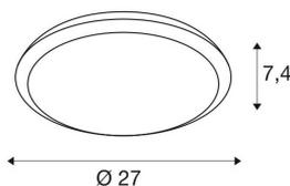
Mit der RUBA Leuchte erhalten Sie eine universell einsetzbare Wand- und Deckenleuchte für den Außenbereich. Zur Verfügung stehen drei verschiedenen Durchmesser jeweils mit oder ohne Bewegungsmelder mit Mikrowellen-Technik. Die Lichtfarbtemperatur ist bei allen Version schaltbar. Der elektrische Anschluss erfolgt direkt an 230V Netzspannung.
